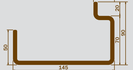
PILAR CENTRAL ESPESOR | 3,5mm / 4,5mm ALEACIÓN | 6082
